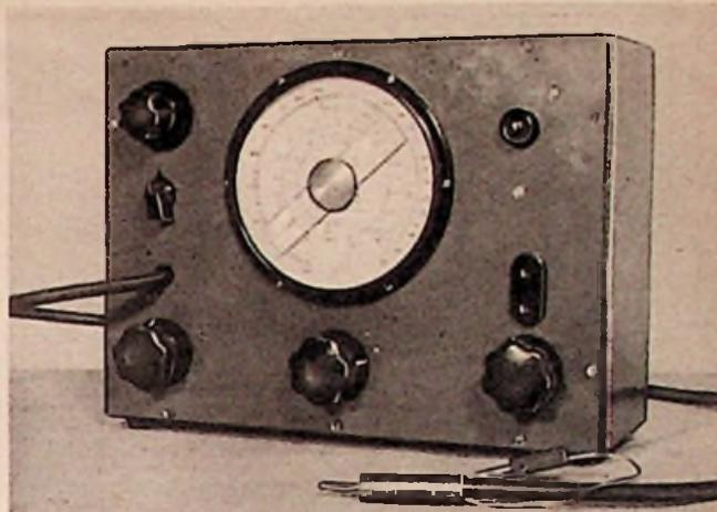
Auf der Frontplatte des »Unitest« sind alle Bedienungsriffe untergebracht. Das Buchsenpaar dient zum Anschluß der Fremdmodulation, die ein Tongenerator oder ein Plattenspieler liefert
