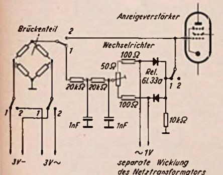
Umformung der Gleichspannung in eine Wechselspannung mit Hilfe eines ruhenden Wechselrichters
