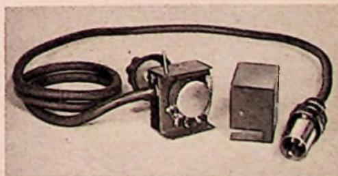
Um kleine HF-Spannungen einstellen zu können, muß der Ausgangsspannungsregler sorgfältig abgeschirmt werden. Er ist hier mit dem zugehörigen Abschirmkästchen und dem HF-Abschirmkabel mit Anschlußstecker sichtbar
