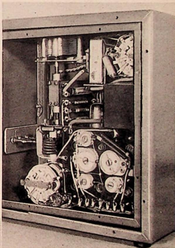
Oben erkennt man den Innenaufbau des HF-Teiles mit Drehkondensatoraggregat, UKW-Spule, Spulenaggregat für die übrigen Bereiche und der darüber befindlichen Abschirmkappe für den Ausgangsspannungsteiler
