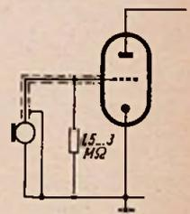
Bild 5. Prinzipschaltbild für den Anschluß von Kristallmikrofonen an den Verstärkereingang
