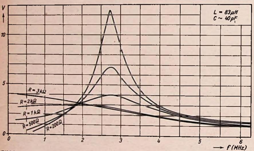
Bild 50. Verstärkung als Funktion der Frequenz für einen RC-gekoppelten Verstärker mit Serienspule von 83 μH (Kreiskapazität 40 pF)
