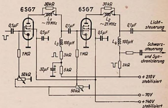
Bild 48. Praktisch ausgeführte Schaltung eines zweistufigen Bildverstärkers
