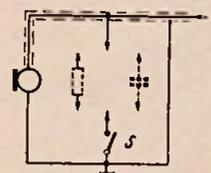
Bild 4. Verwendung des Schiebenschalters zum Ein- und Ausschalten des Mikrofons oder zur Geräuschdämpfung
