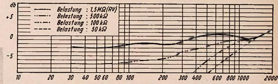
Bild 3. Dämpfung der Tiefen bei verschiedenen Belastungswiderständen, gemessen unter Zwischenschaltung eines Anschlußkabels von 600 pF mit Hilfe eines Röhrenvoltmeters (Eingangswiderstand 1,5 MΩ). Waagrecht sind die Frequenzen in Hertz aufgetragen
