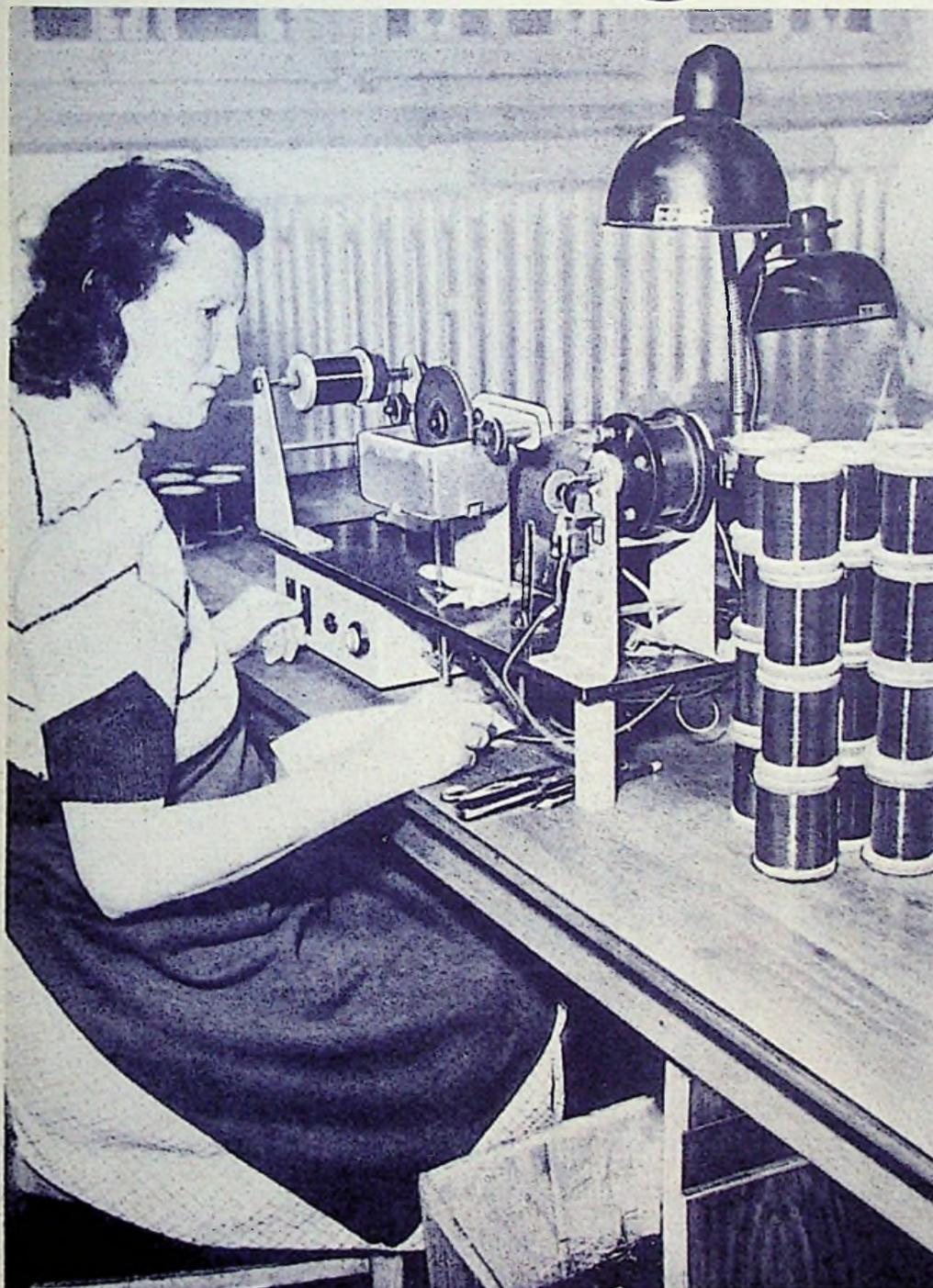
Im Telefunken-Rundfunkgerätekwerk Hannover werden automatische Drahtprüfmaschinen verwendet, die eine Prüfung der lackisolierten Drähte auf Fehler ermöglichen. Die abgebildete Maschine wickelt die selbsttätig eine einstellbare Länge Draht auf und führt ihn dabei durch ein elektrisch leitendes Bad. Bei Fehlern in der Isolation wird über den zu prüfenden Draht und das Bad ein Stromkreis geschlossen, der mit einem Zählrelais die Zahl der Fehler registriert. (Foto: Carl Stumpf)
