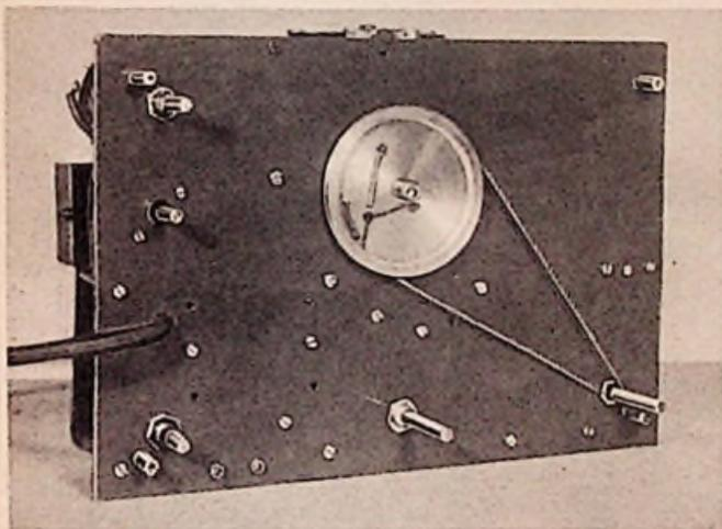
Diese Aufnahme zeigt die Zwischenfrontplatte, die aus Abschirmungsgründen angeordnet ist. Sie enthält vier Zwischenlöcher zur Befestigung der eigentlichen Frontplatte
