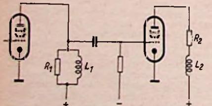
Bild 51. Versuchsschaltung zur Linearisierung des Frequenzgangs
